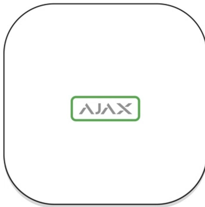
Il logo Ajax sulla parte anteriore dell'hub si illumina di rosso, bianco o verde a seconda dello stato dell'alimentazione e della connessione a Internet.
